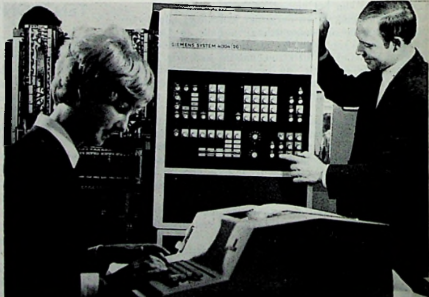
Afb. 2. Een nieuwe rekenmachine - model 4004 - 26, de „goedkope” computer, opgebouwd met IC's. Cyclustijden in het nanosecondenbereik. (Siemens)
